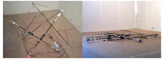
图3 六杆张拉整体机器人六边形折叠
