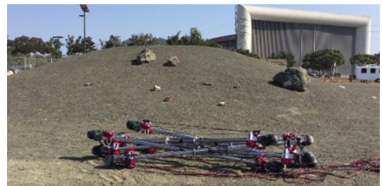
图4 六杆张拉整体机器人一维构型折叠
