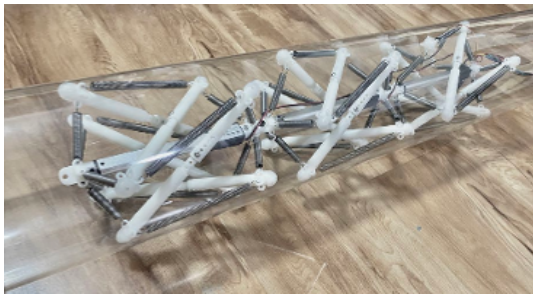
图1 基于张拉整体结构的管道爬机器人 Fig.1 The tensegrity structures-based in-pipe crawling robot
