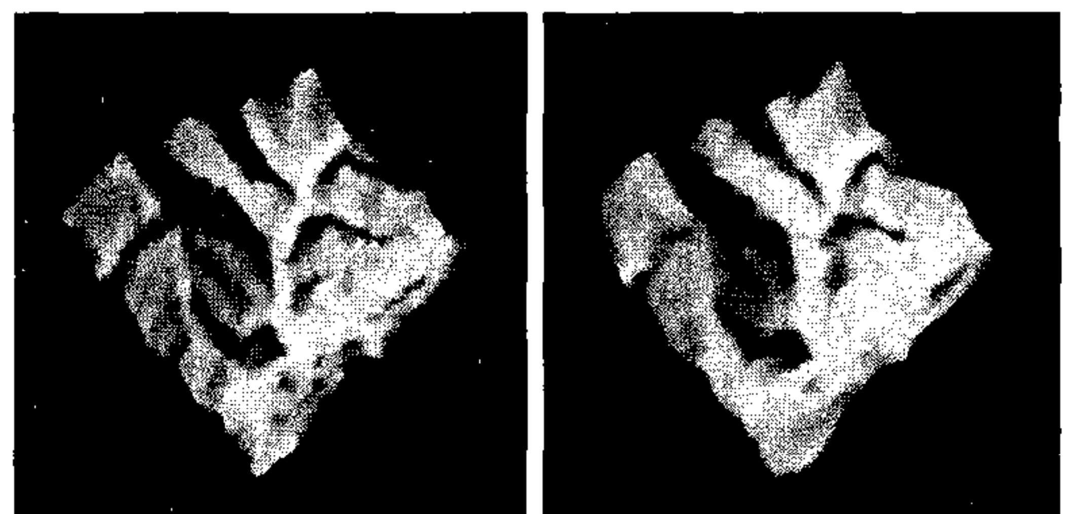
(a)简化模型1 (1874个三角形,简化77.1%) (b)简化模型2 (543个三角形,简化93.4%)
