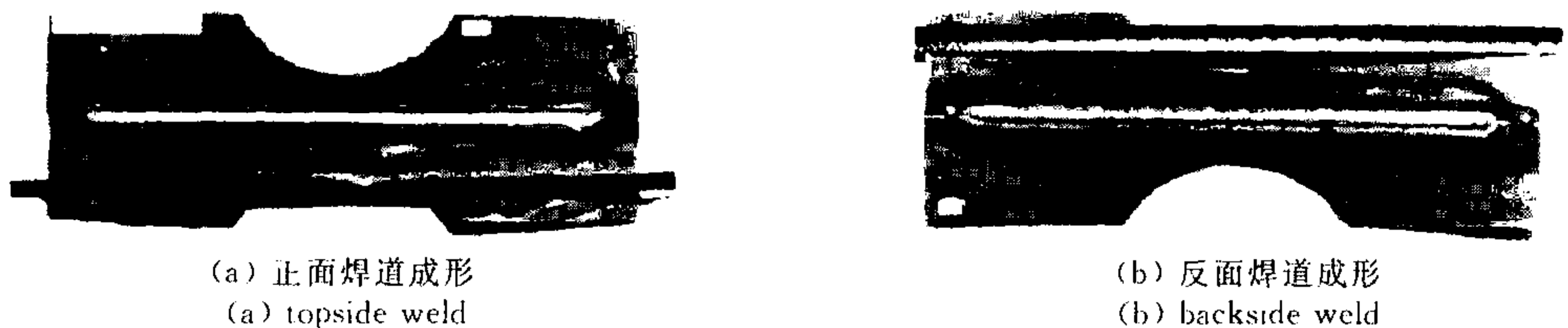
图 4 圆弧形试件脉冲 GTAW 双变量智能控制焊道照片
