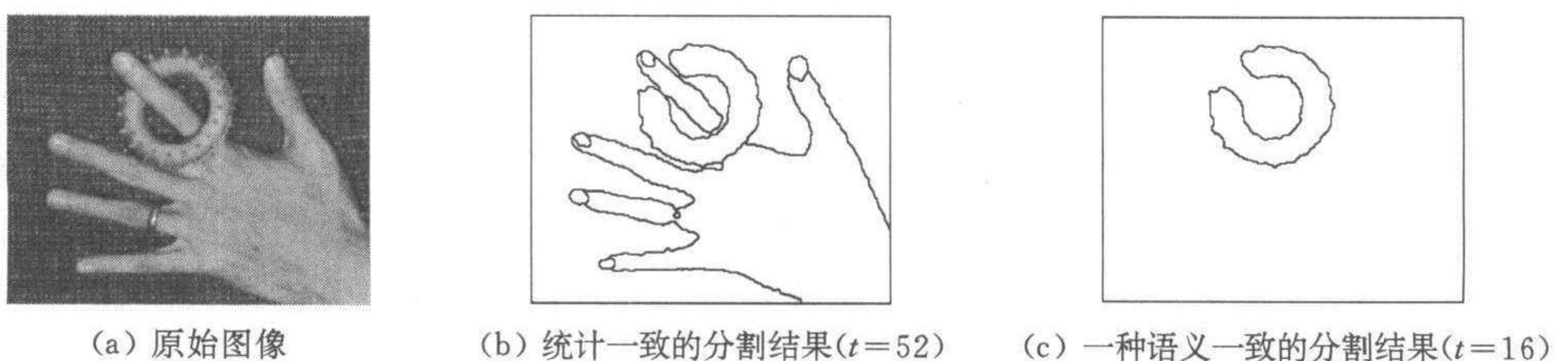
图 2 人手图像实验结果(其中 t 表示竞争算法中的循环数)
