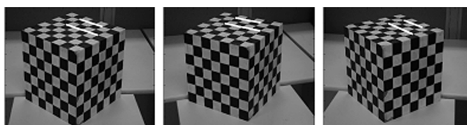
图 5 已知图像极点时，用于标定摄像机的真实图像
