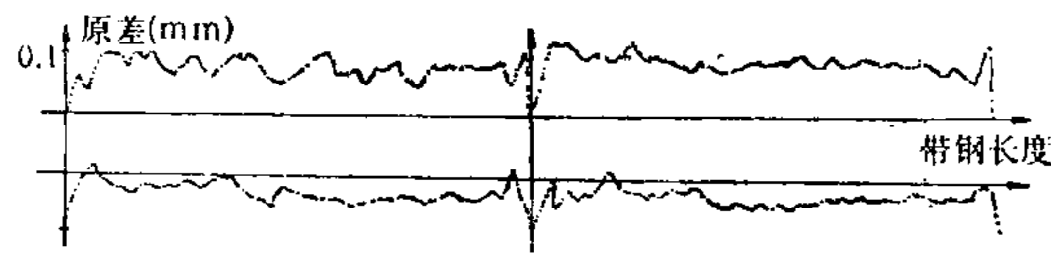
图 4 实测 3mm 钢板厚差记录曲线
