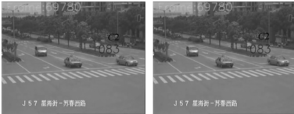
(b) 第 69 780 至 70 560 帧的判别结果 (b) The results from 69 780 to 70 560 frames 图 13 直行车辆行驶自动判别
