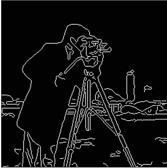
图 16 含噪声时阈值为 [0.06 0.15] 时, Canny 算子的检测结果
