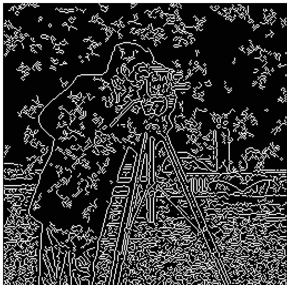
图 12 含噪声时默认阈值下 \alpha = 0.8 , m = 1 , width = 2 的检测结果
