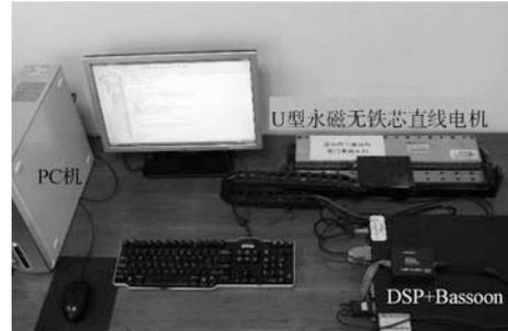
图 6 永磁同步直线电机伺服系统
