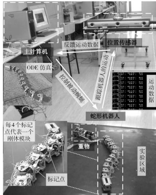
图 9 蛇形机器人被动蜿蜒控制的实验系统
