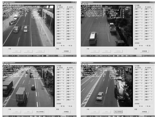
图7 视频检测器的主机交互软件
