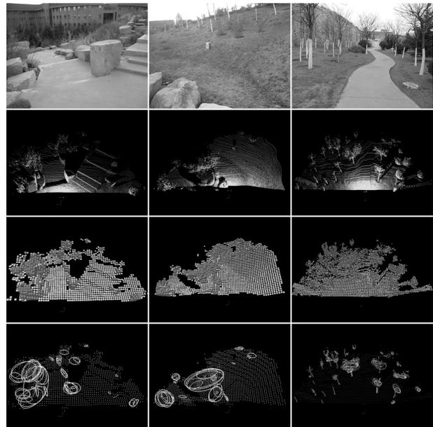
图 12 多个场景的拓扑高程图构建过程
