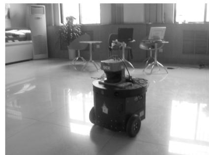
图6 装配激光测距仪的实验机器人
