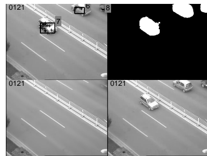
图 5 本文算法对多个目标的跟踪效果 Fig. 5 Effect of multi-object tracking using our method
