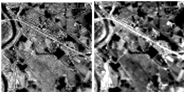
(c) 基于对比度 \hat{\alpha} trous 的 Contourlet 变换的融合算法结果 (c) Fused image of using contrast \hat{\alpha} trous wavelet contourlet transform (d) 基于独立分量分析和 \hat{\alpha} trous 小波变换的融合算法结果 (d) Fused image of using independent component analysis and \hat{\alpha} trous wavelet transform
