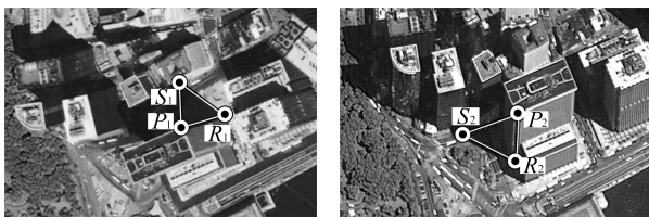
(a) 图 I_{t1} 中的几何特征三角形 (b) 图 I_{t2} 中的几何特征三角形 (a) An example of GFT in I_{t1} (b) An example of GFT in I_{t2}
