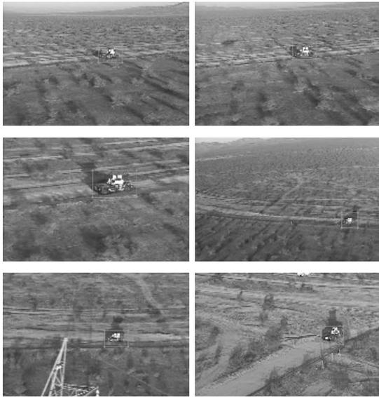
图9 穿梭于草地、沙漠公路上的车辆 HMS 算法跟踪结果
