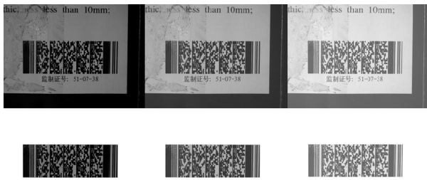
图 5 PDF417 二维条码图像在不同光照下检测定位
