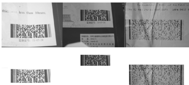
图 6 PDF417 二维条码图像扭曲皱褶时检测定位
