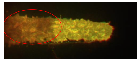
图 5 受粉尘干扰的铁水流图像 Fig.5 Molten iron flow image under dust interference
