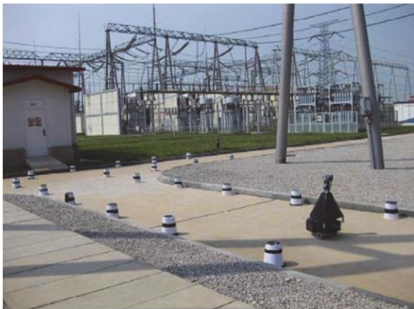
(b) 国家电网红外全方位视觉导航巡检机器人 (b) State Grid infrared omnidirectional visual navigation inspection robot
