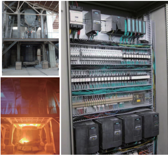
图 6 电熔镁炉 PID 控制过程
