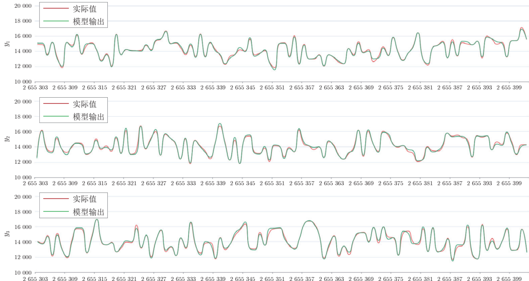
(a) 电流实际值与云模型输出曲线
