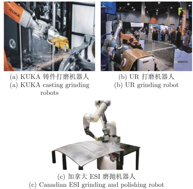
图 9 铸件表面清理机器人现场打磨作业场景
