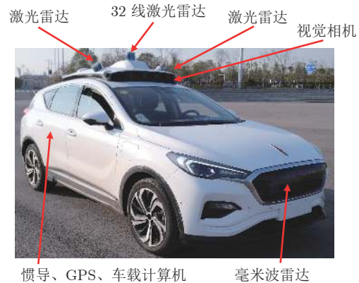
图 7 红旗 E-HS3 智能驾驶平台 Fig.7 Hongqi E-HS3 intelligent driving platform
