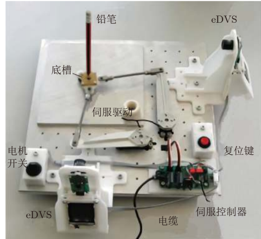
图 16 铅笔倒立平衡控制系统: 两台 DVS 事件相机进行线检测 (右上角及左下角), 左上角运动平台由中间两部伺服电机驱动 [81]
