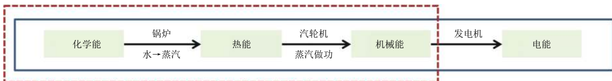
图 1 发电过程能量转化简图 (虚线框内为热力系统的能量转化过程)
