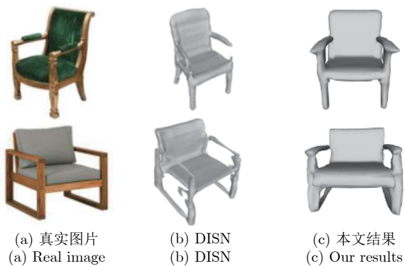
图 2 本文方法和 DISN 方法在真实图像上的单视图重建结果
