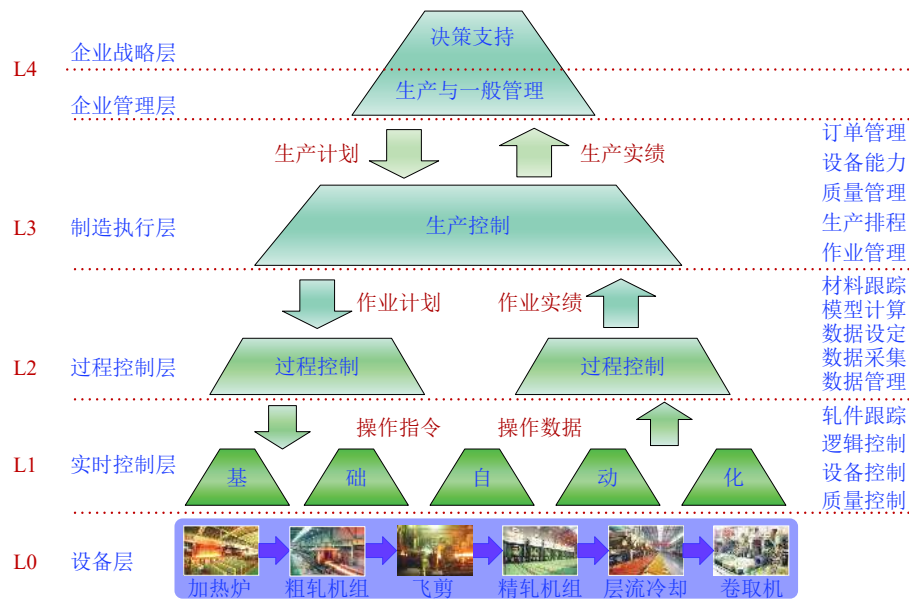
图 6 热轧过程综合自动化系统示意图
