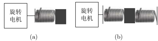
图 4 基于螺旋扭转弹簧的弹性装置
