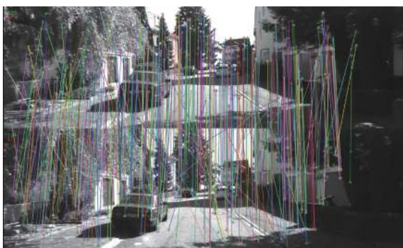
(a) 单纯使用光流匹配特征点的结果 (a) Feature matching only used optical flow
