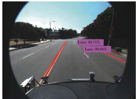
图 8 车道线测试效果 Fig.8 The result of lane line test
