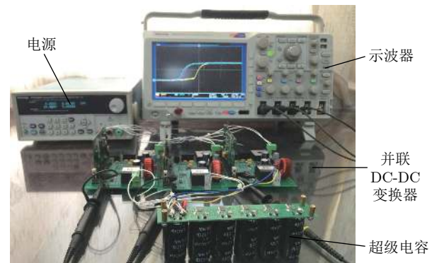
图 8 均流实验平台 Fig.8 Hardware setup
