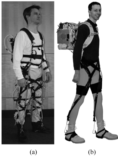
图 11 柔性助力外衣 Fig. 11 Soft exosuit
