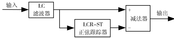
图1 二阶惯性滤波器内部结构示意图
