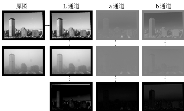
图 3 空气污染对图像灰度通道和彩色通道的影响
