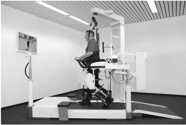
图 2 瑞士 Hocoma 公司的 Lokomat 下肢康复机器人
