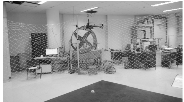
图 2 四旋翼无人机吊挂飞行系统实验平台
