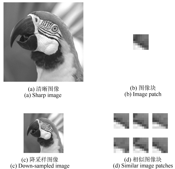
图 1 图像不同尺度间的结构自相似性
