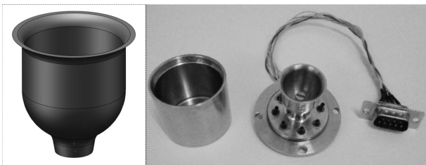
图 2 钟形振子式角速率陀螺
