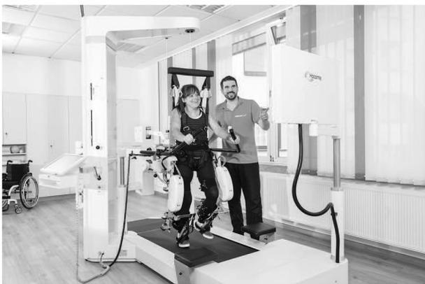
图 1 Lokomat 康复机器人<sup>[18]</sup>
