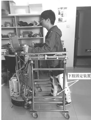
图 6 离线跌倒数据采集实验图
