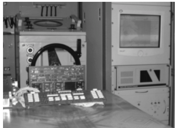
图 3 船舶航迹控制模拟系统
