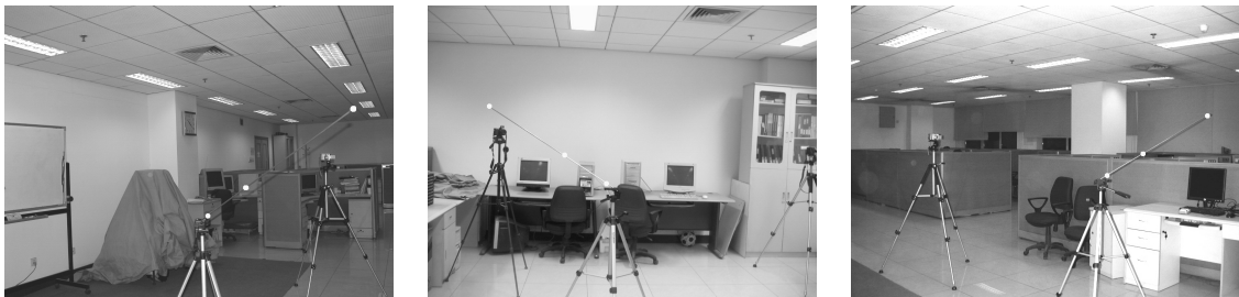
图 4 用于多摄像机标定的 1D 标定物的图像 (三幅图依次对应第 1、2、3 个摄像机)
