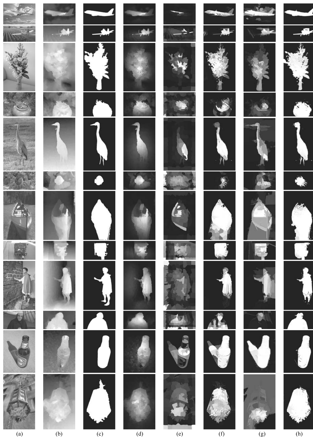
图 15 NJU-DS2000 数据集颜色-深度显著情况显著图对比 ((a) RGB 图像; (b) Depth 图像; (c) 真值图; (d) ACSD 方法; (e) GMR 方法; (f) MC 方法; (g) MDF 方法; (h) 本文方法)
