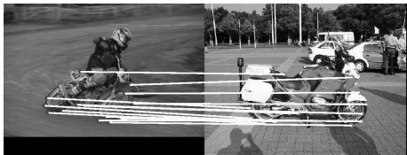
图 14 摩托车真实图像配准实例 (取自 Pascal 2007 challenge 数据库 [45] 的第 4 对摩托车图像, 图中连线代表特征点之间的对应关系.)
