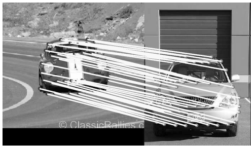
图 13 汽车真实图像配准实例 (取自 Pascal 2007 challenge 数据库 [45] 的第 18 对汽车图像, 图中连线代表特征点之间的对应关系.)
