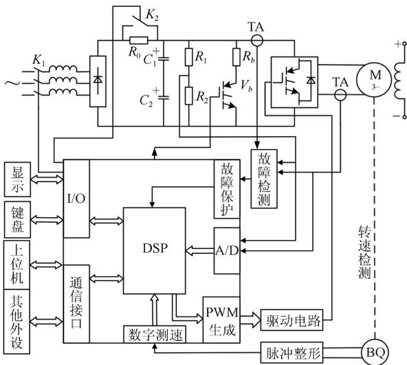
(b) 实验平台结构原理图
