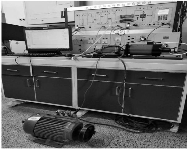
(a) 电力电子与电气传动综合实验平台
