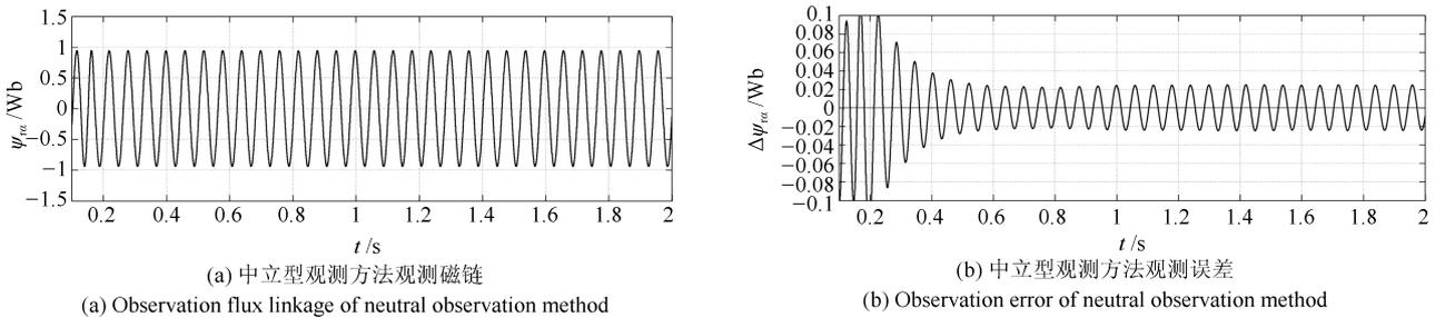
图 8  $R_r$  值变为真实值的 0.5 倍磁链观测图
