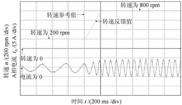
(b) 电机转速阶跃波形及对应A相电流波形
