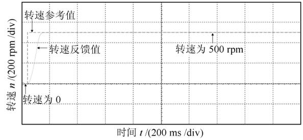
(a) 电机转速响应图
