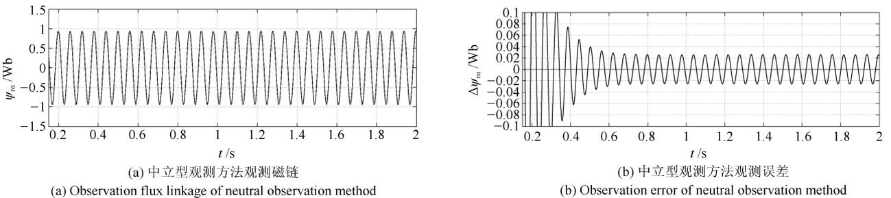
图 9  $L_r$  值变为真实值的 0.5 倍磁链观测图
