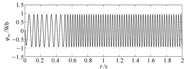
(b) 中立型观测方法调速观测磁链
