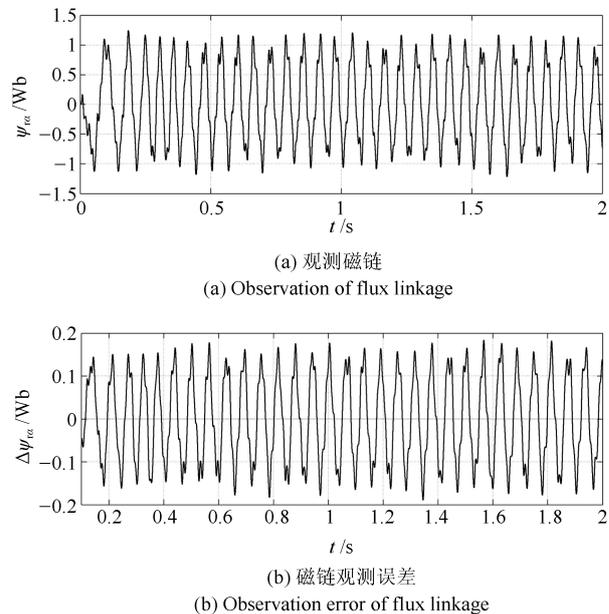
图 13 加延迟后电压模型法磁链波形
