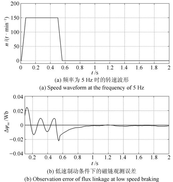
图 12 基于中立型观测方法的感应电机低速运行波形
