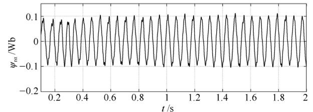
(d) 电压模型法观测误差
