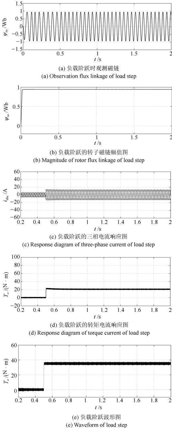
图 11 基于中立型观测方法的负载阶跃的响应波形
