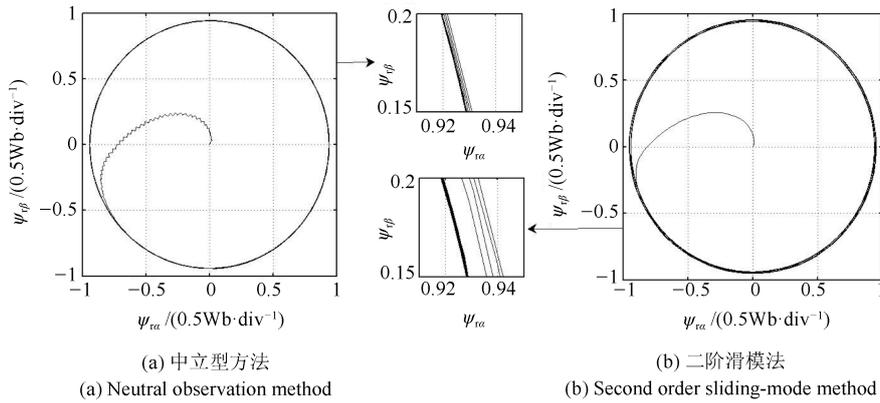
图 6 中立型观测方法和二阶滑模观测方法观测磁链对比图
