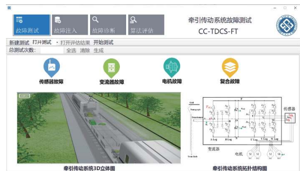
图 9 牵引传动系统故障测试软件的用户界面
