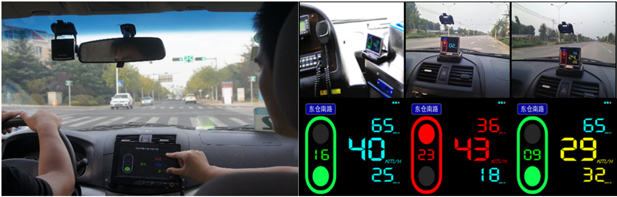
图3 2014年IEEE智能交通年会上中国多家高校和企业联合演示的基于车路协同技术的交通信号提示和车辆速度导引控制
