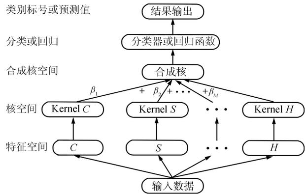
图 1 多核函数线性组合合成示意图
